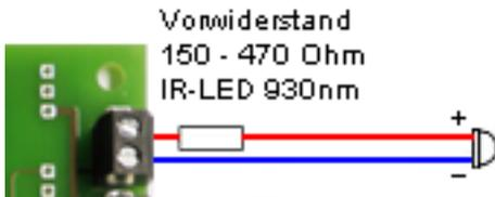
Der Widerstandswert bestimmt den Abstand, in dem ein Auto den abgestrahlten Befehl erkennt.
