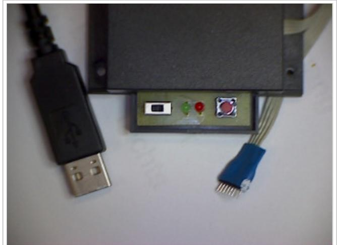
fertiges Programmiergerät mit USB-A-Anschluss, Einschalter, LED USB / LED Fahrzeug-Spannung, Taster, Programmierstecker 1x8 polig
